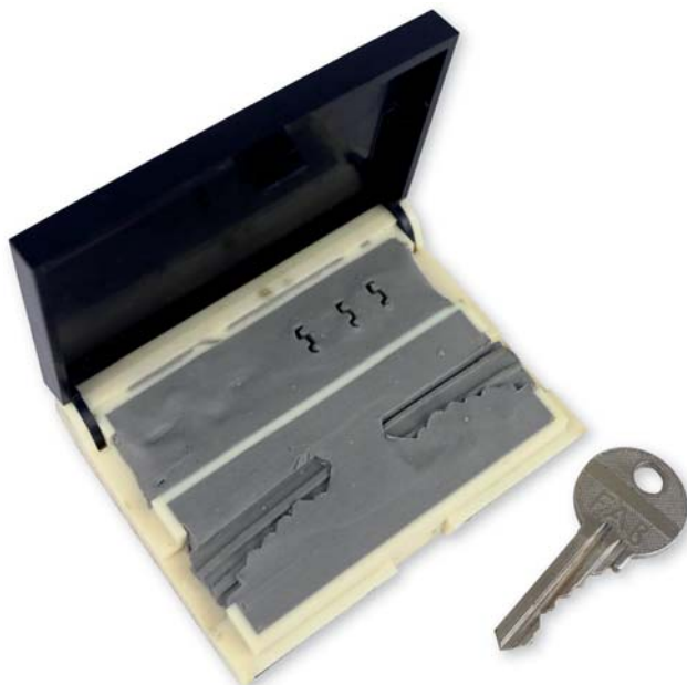
Přípravek pro zhotovení otisků klíčů a jejich následnou výrobu pro potřeby operativy StB (Muzeum paměti XX. století)
